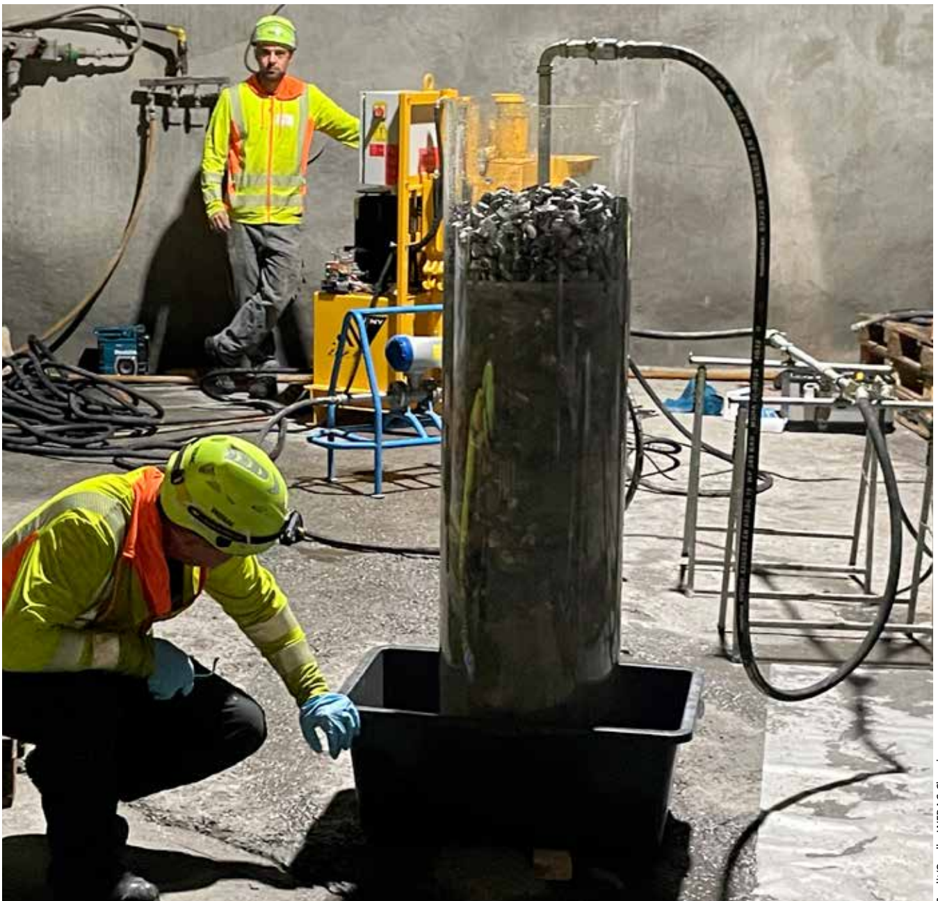
1 Application of the innovative hybrid injection system HIS during a presentation in the Hagerbach Test Gallery in Switzerland Einsatz des neuartigen Hybrid-Injektions-Systems anlässlich einer Präsentation im VersuchsStollen Hagerbach in der Schweiz
